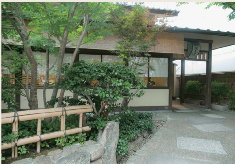
緑も含めその景観全体が、利用者・通行人を問わず、皆の目を楽しませている。実は木造ではなく鉄骨造というから驚き。
